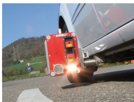
Figura 28: retroriflettometro per segnaletica orizzontale a sinistra e retroriflettometro montato su veicolo a destra - Fonte: https://www.screeningeagle.com/it/products
