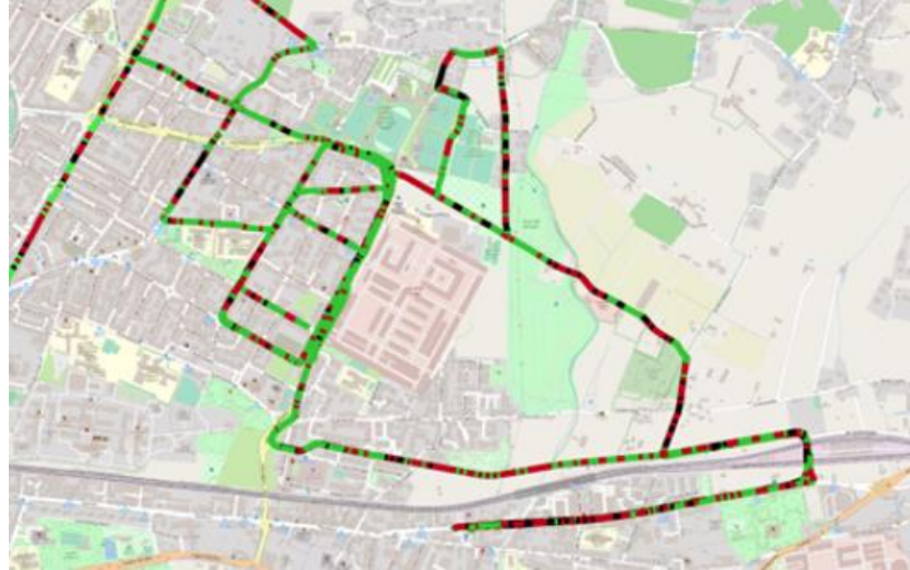
Figura 8: Esempio di mappa con indicatori di degrado stradale
